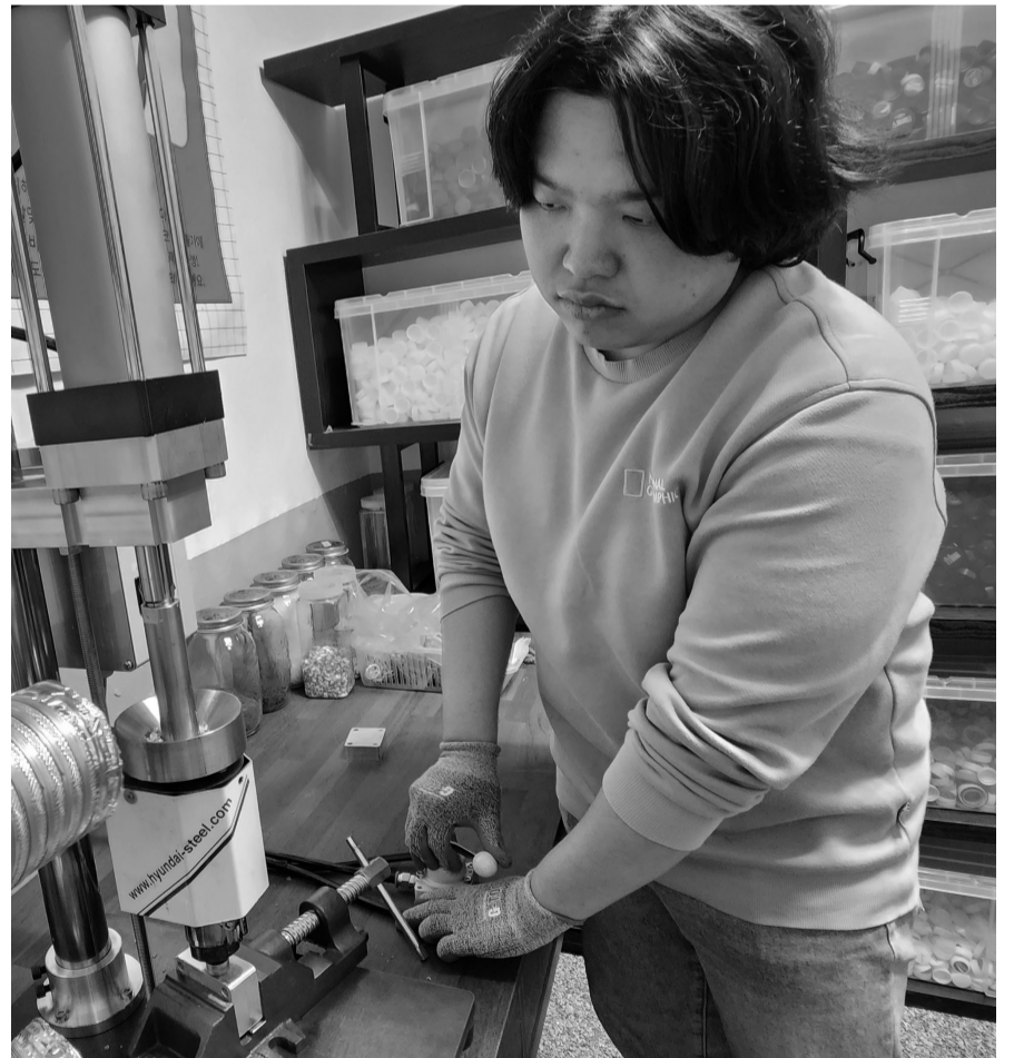
페플라스틱 쓰레기를 재활용하기 위해 사출기를 활용해 분쇄하고 있다. 몇단계 과정을 거친 뒤 화분, 열쇠고리 등으로 재탄생 된다.
