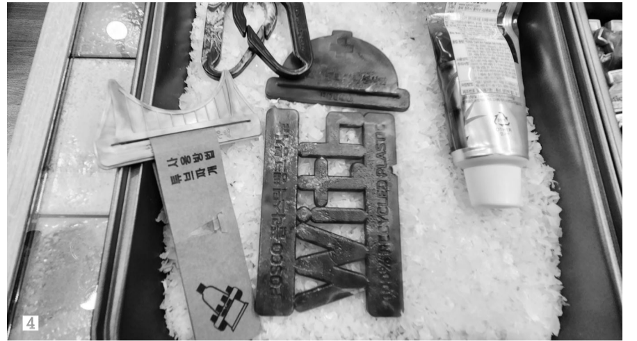
1 포스코광양제철소 플라스틱뱅크에서 시민들이 페트병 뚜껑을 색상별로 분류하고 있다. 2 페트병 뚜껑 색상별 분류작업을 마친 뒤 파쇄기에 투입하고 있다. 3 페트병 뚜껑이 파쇄과정을 거쳐 금형 되는 과정 4 페트병 뚜껑이 치약 짜개, 비누받침대, 열쇠고리 등 완성품으로 만들어져 나오고 있다.
