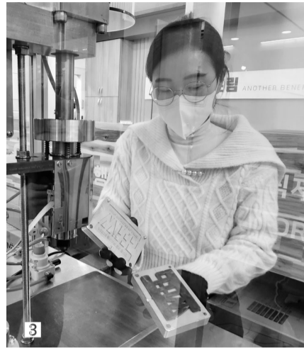
1 포스코광양제철소 플라스틱뱅크에서 시민들이 페트병 뚜껑을 색상별로 분류하고 있다. 2 페트병 뚜껑 색상별 분류작업을 마친 뒤 파쇄기에 투입하고 있다. 3 페트병 뚜껑이 파쇄과정을 거쳐 금형 되는 과정 4 페트병 뚜껑이 치약 짜개, 비누받침대, 열쇠고리 등 완성품으로 만들어져 나오고 있다.
